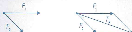
Abb. 3.2: Kräfteparallelogramm und geometrische Addition
